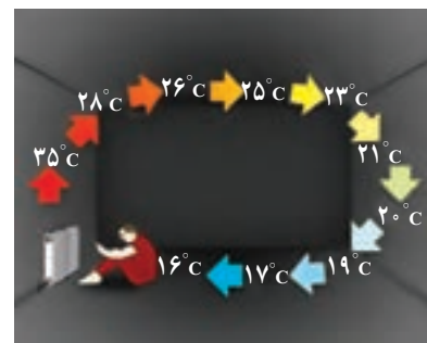
شکل ۴-۳۲ گرم شدن هوای اتاق به روش همرفت
