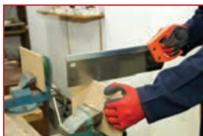
الف- بریدن قطعات با اره ظریف بر
