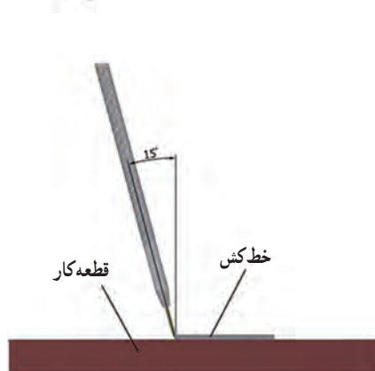
شکل ۱-۴- روش صحیح خط‌کشی با خط‌کش و سوزن خط‌کش
