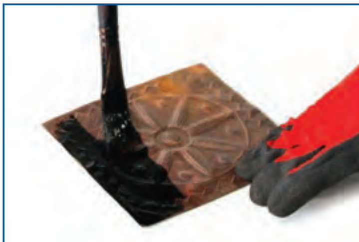
شکل ۱۰-۱۰- آغشته کردن سطح پلاک مسی به قیر
