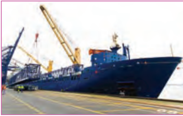
الف - نصب جرثقیل بر روی کشتی
