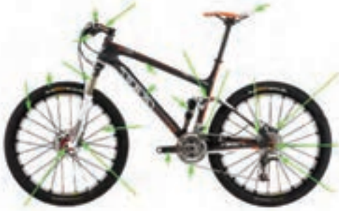
شکل ۳ - دوچرخه از اجزای مختلفی مانند: اهرم، پیچ و مهره، چرخ و محور، چرخ و دنده و... تشکیل شده است.
