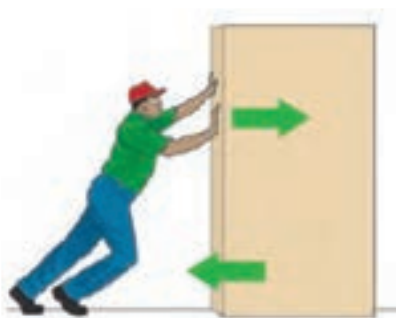
شکل ۲- شخص به جعبه ساکن نیرو وارد می‌کند ولی جعبه حرکت نمی‌کند زیرا نیروی روبرو به جلو با نیروی اصطکاک رو به عقب هم‌اندازه‌اند.
