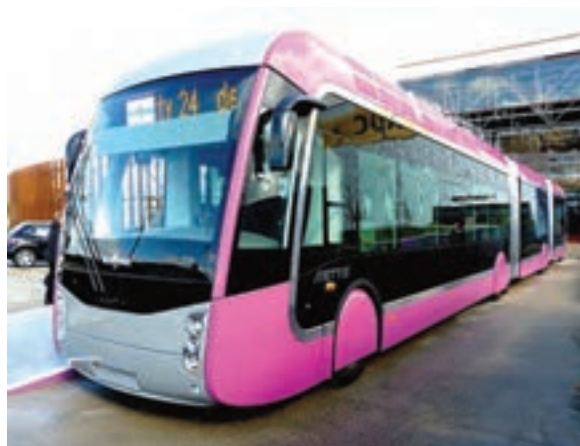
اتوبوس هیبریدی* (دیزل - الکتریکی) فرانسه
