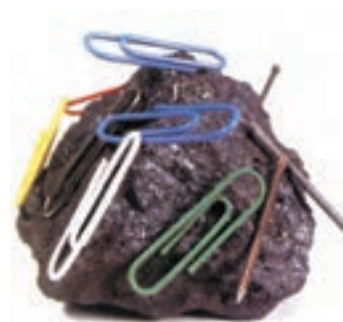
شکل ۳-۱ سنگ آهنربای طبیعی. تالس که اغلب از او به عنوان پدر علم یونان یاد می‌شود، ماده کانی مگنتیت Fe_3O_4 را که ویژگی آهنربایی دارد می‌شناخت.
