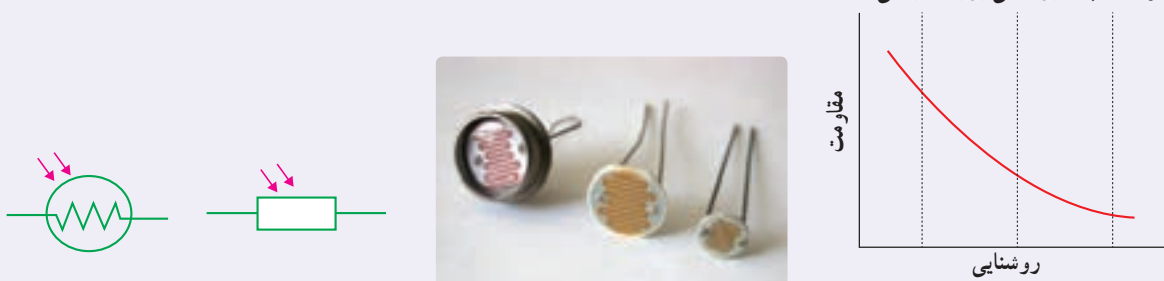
(ث) نماد LDR در دو استاندارد متفاوت
