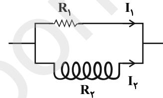
$$V_{\text{پایین}} = V_{\text{بالا}} \Rightarrow I_1 R_1 = I_2 R_2$$
