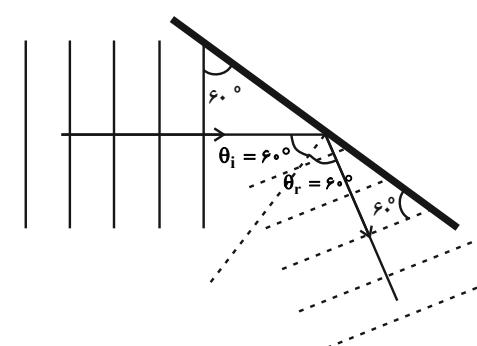
از طرف دیگر، چون جبهه‌های موج بازتابیده عمود بر پرتوی موج بازتابیده است، مطابق شکل، زاویۀ برخورد جبهه‌های موج بازتابیده با سطح مانع تخت برابر  $\theta = 60^\circ$  است.
